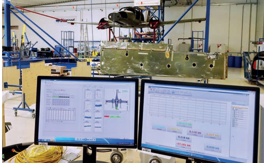
Der Dauertest mit tausenden Zyklen kann aufgrund der übersichtlich in LabVIEW automatisierten Tests mit frei definierten Kraftzyklen zügig und exakt nach Vorgaben der Luftfahrtbehörde durchgeführt werden.
