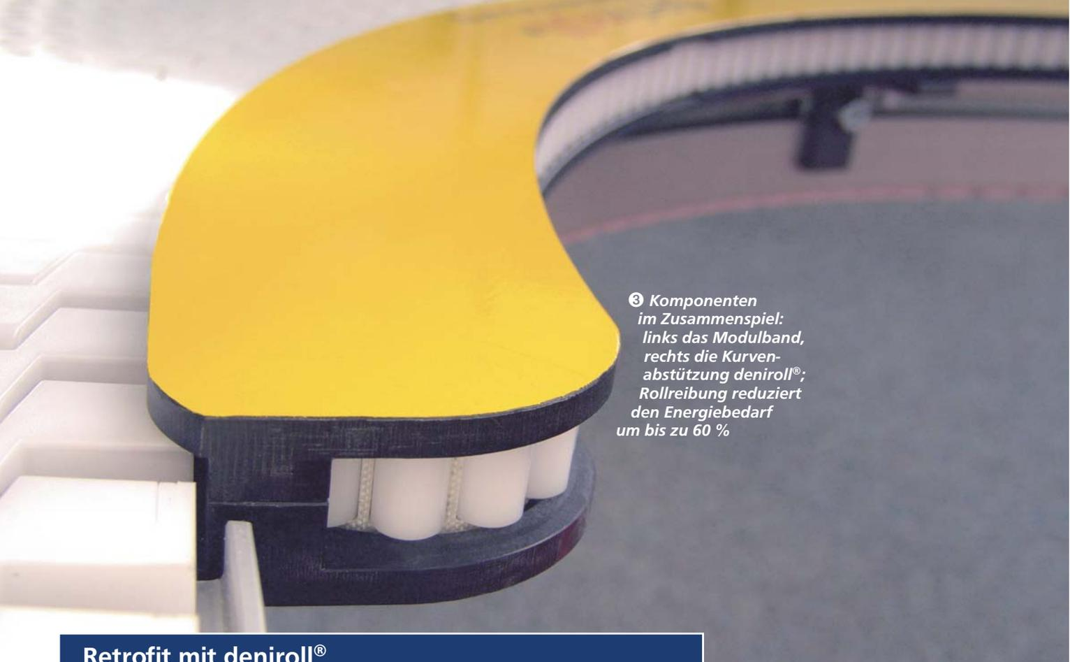
③ **Komponenten im Zusammenspiel:** links das Modulband, rechts die Kurvenabstützung deniroll®; Rollreibung reduziert den Energiebedarf um bis zu 60 %
