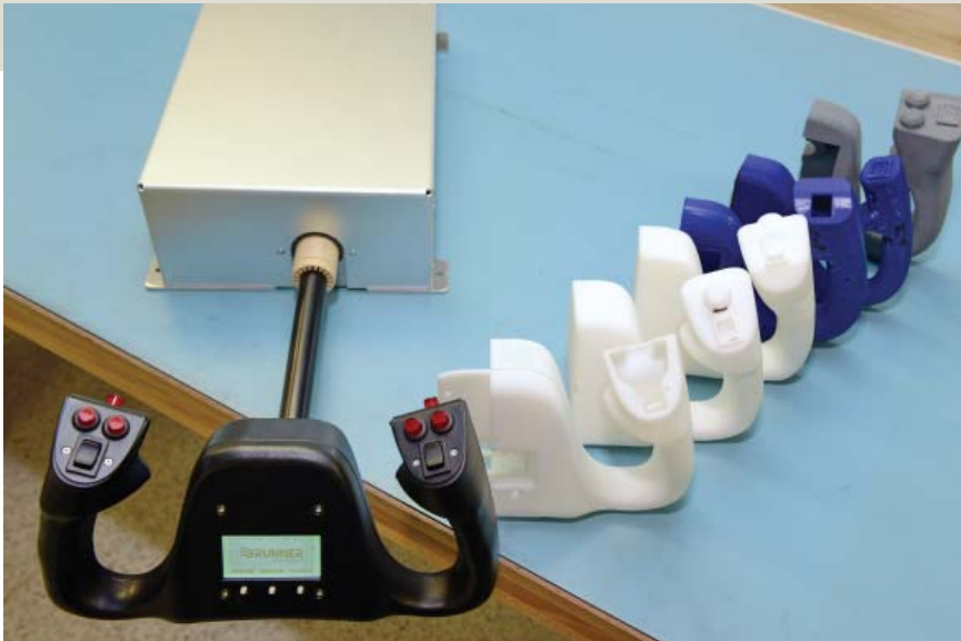
Evolution von ersten Entwürfen bis zum optimierten Steuerknüppel mit voller Funktionalität und integrierter Elektronik – konstruiert in Solid Edge und als Modelle im hauseigenen 3D-Drucker ausgedruckt. (Bild: M. Frutig)
